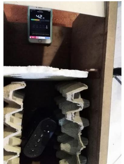
ILUSTRACIÓN 27 PRUEBA Y RESULTADOS INSONORIZACIÓN - LAMINA DE POLIURETANO.
