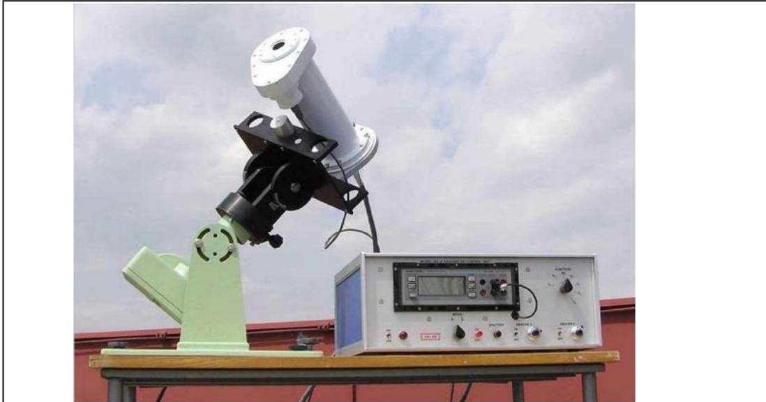
Figura 5. Pirheliómetro Eppley H-F y Unidad de Control 405
