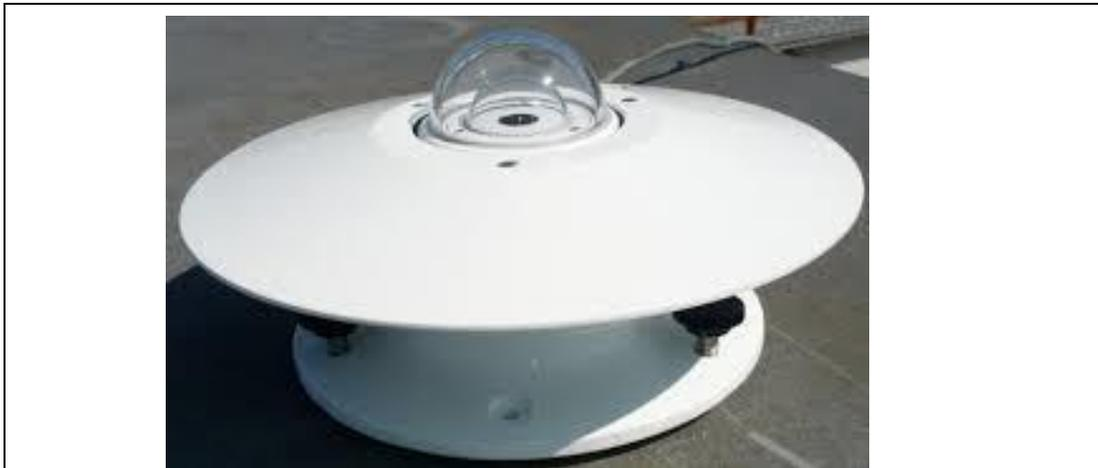
Figura 6. Piranómetros Eppley modelo PSP
