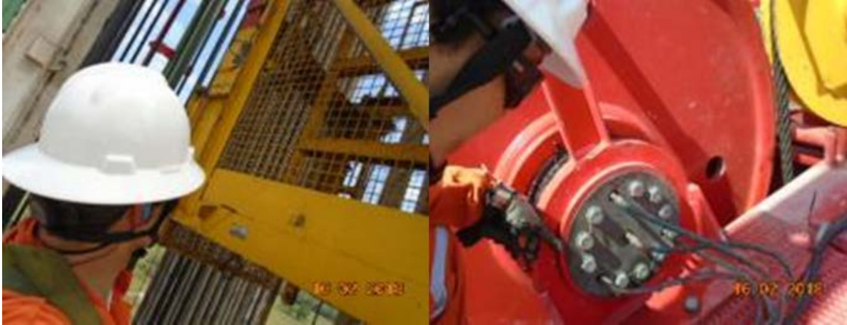
Ilustración 2. Inspección DROPS, caída de objetos. Inspección de aseguramiento principal y retención secundaria de los elementos de la subestructura. Departamento de QHSES de Petrex Sucursal Colombia. Reporte diario HSE 16/02/2018. Reimpreso con permiso.
