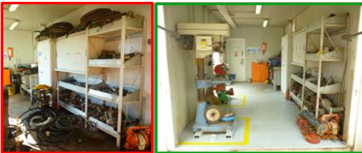
Ilustración 8. Inspección de orden y aseo de almacenes. Jornada de orden y aseo en almacenes mecánicos aplicando la metodología de las 5's. Departamento de QHSES de Petrex Sucursal Colombia. Reporte diario HSE 17/02/2018. Reimpreso con permiso.
