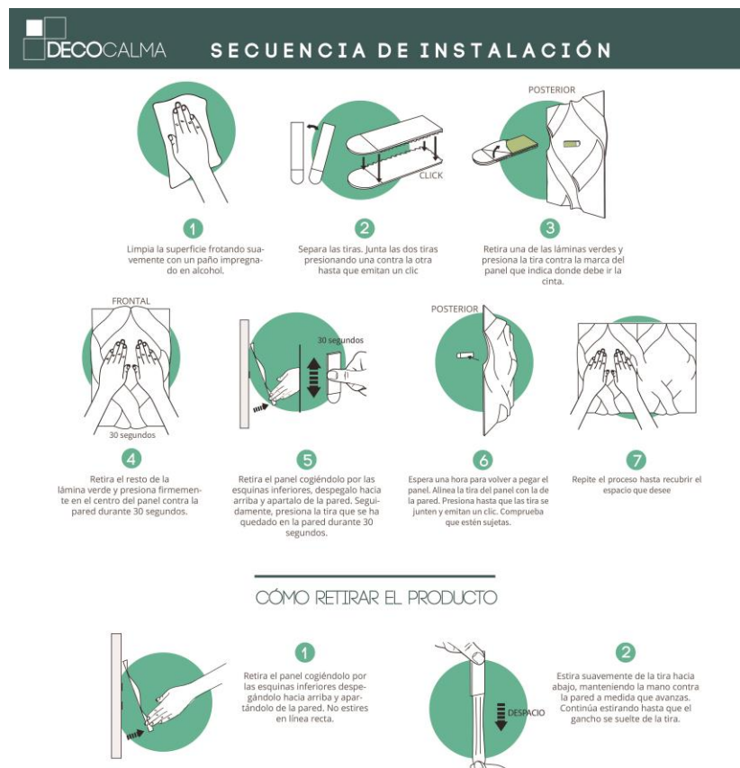
Figura 11. Secuencia adaptada de las cintas command 3M a la instalación del panel. Elaborado por el autor.
