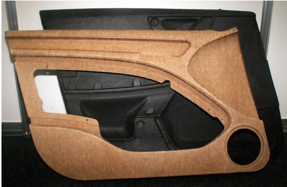
Figura 1. Compuesto de fibra natural aplicado a panel de puerta interior en la industria automotriz.
