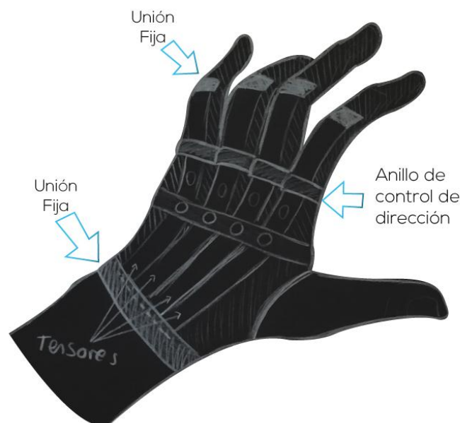
Figura 29: Guante de tensores. Fuente: propia.
