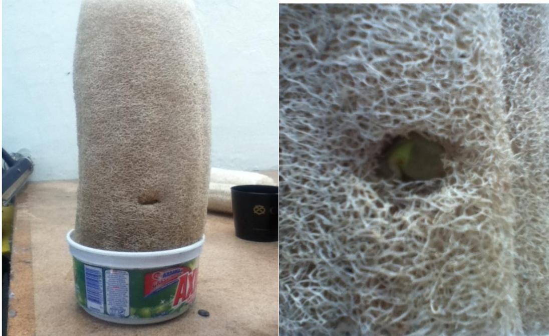
Figura 4. Prueba de capilaridad de la fibra
