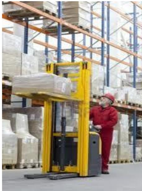
**Ilustración 57:** Apilador eléctrico
