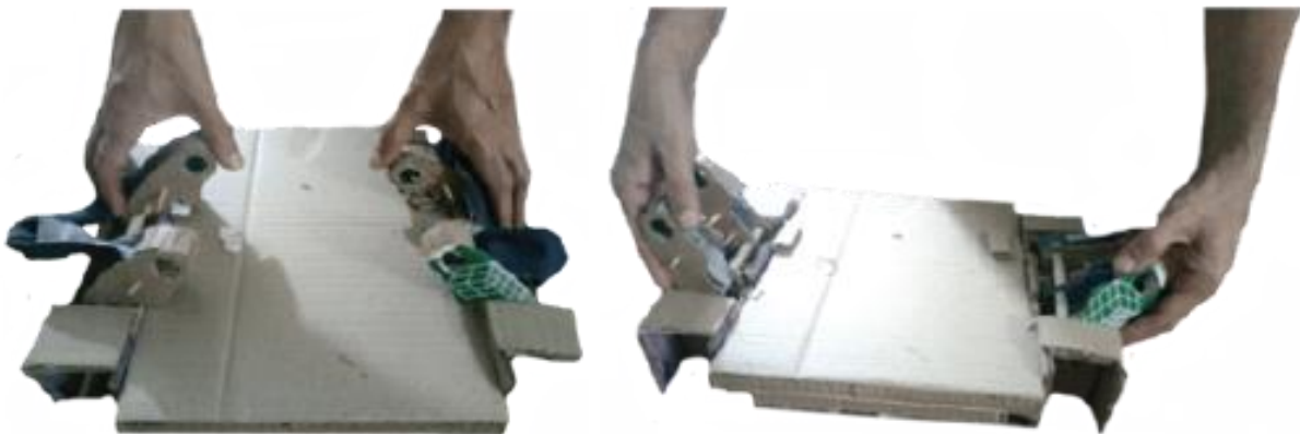
Figure 49. Secuencia de desbloqueo de la tapa (de izquierda a derecha)
