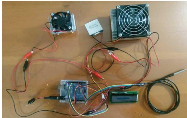
Figure 36. Sistema de refrigeración
