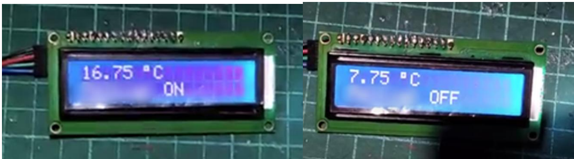
Figure 44. Comprobación del sistema de refrigeración.
