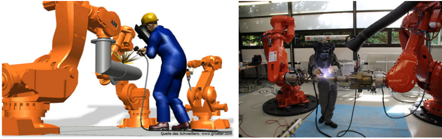
Abb. 3 Das Beispiel RoRaRob zeigt, wie der Mensch langsam in den Mittelpunkt rückt. Schwere Teile werden von Robotern in für den Schweißer jeweils günstige ergonomische Positionen bewegt. Das Tätigkeitsprofil des Schweißers ändert sich dadurch kaum, Quelle : Institut für Produktionssysteme, TU Dortmund (Bild links: grueter.com /Max Grueter)
