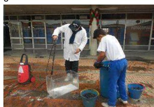
Se lava el material filtrante y el humedal luego de realizado un ensayo. Se garantiza que no existan interferencias en el ensayo siguiente
