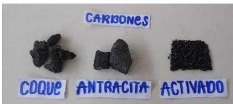
**Figura 11.** Materiales granulares empleados en los ensayos
