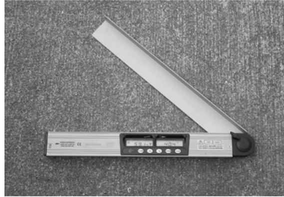
Laser-Winkelmessgeräte mit Gefälle-Ablesung in Prozent oder Grad.
