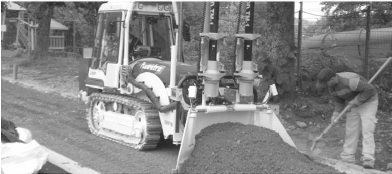
Trakdozer® Same Krypton3 80 «Lejan» mit Zulassung für Straßenverkehr. Der Trakdozer®, geeignet für schmale Flächen wie zum Beispiel Fußwege, bei Planierarbeiten mittels Laser- und Ultraschallsteuerung.
