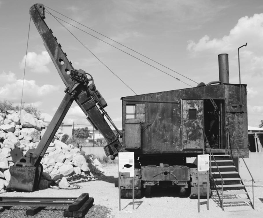
Menck Dampfbagger, Baujahr 1927, 50 – 55 Tonnen. Für den Betrieb des Baggers waren drei Arbeiter notwendig (Fahrer, Heizer, Schmierer). Er war der erste Universalbagger, aufrüstbar mit Tief- und Hochlöffel, Greifer oder Schleppschaukel. Der Bagger ist komplett geschraubt und genietet ([www.monsterbagger.de](http://www.monsterbagger.de)).
