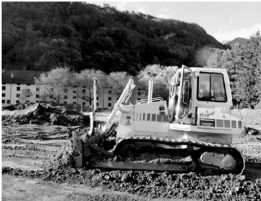
Geländemodellierung des Golfplatzes Bad Ragaz mit einer 3D-Maschinensteuerung von Leica Geosystems.
