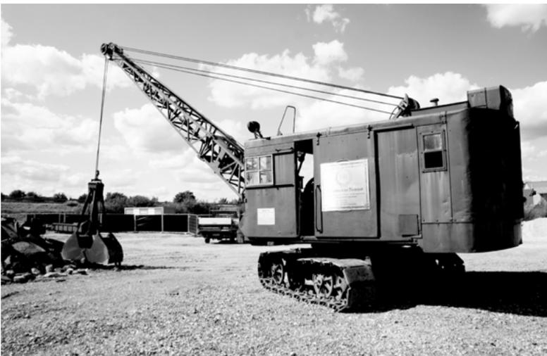
Der 27,5 Tonnen Menck MA (Baujahr 1938) ist der älteste, noch voll funktionsfähige, über Seile gesteuerte Bagger Deutschlands. Er steht im Monsterbagger-Park bei Bamberg.
