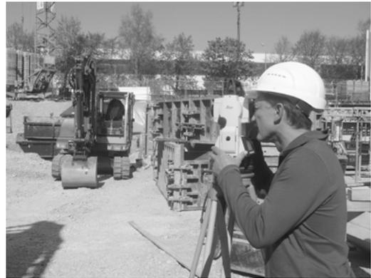
Der Builder von Leica-Geosystems, ein moderner Tachymeter.
