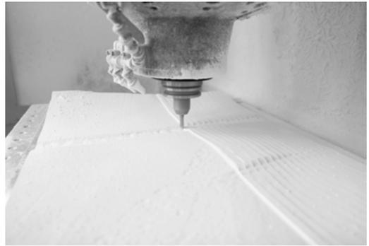
Als Material kommt leichter, UV-beständiger Kunststoff, der auch manuell nachbearbeitbar ist, zum Einsatz.
