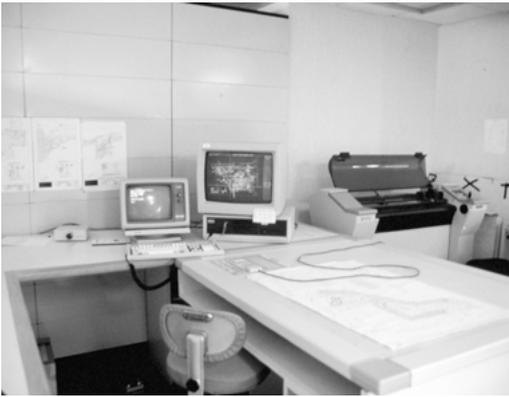
CAD-Arbeitsplatz in einem Landschaftsarchitekturbüro 1988 mit PC (16 Mhz, 8 MB RAM, MS-Dos Betriebssystem, AutoCAD Version 9), Digitalisiertisch und Stifteplotter.
