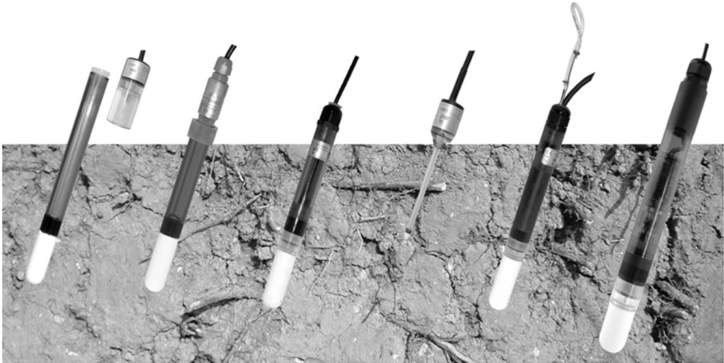
Tensiometer für die Messung der Saugspannung.
