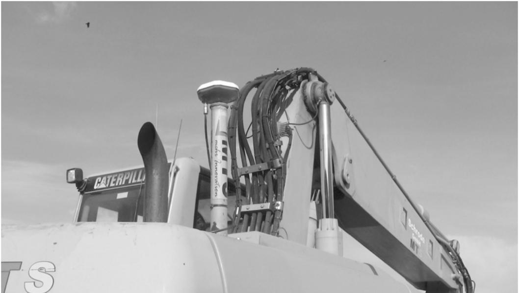
Die 3D-Baggersteuerung MTS-Navi (Maschinentechnik Schrode AG) zeichnet sich durch eine einfache, praxisorientierte Handhabung aus und ist für den Tiefbau und Garten- und Landschaftsbau optimiert.
