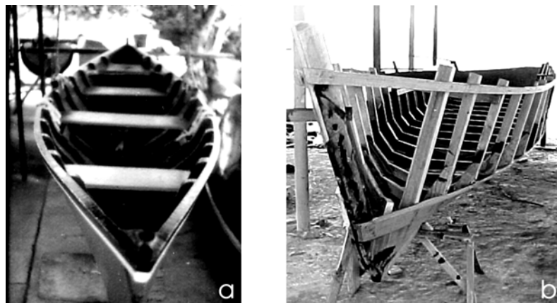
Figura 8. Embarcaciones tipo catboat (a- desde popa; Rocky point) y lancha de madera (b- desde proa; Free town) utilizadas por los pescadores de Providencia y Santa Catalina; se observan las diferencias entre la estructura física de una y otra.
