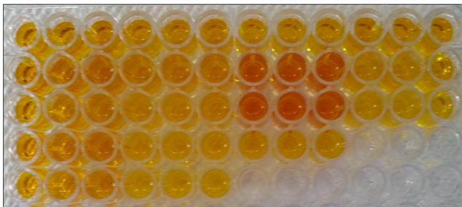
**Figura 14.** Comparación de una prueba positiva (pozos rojos) y negativa (pozos amarillos del método de azúcares reductores y el DNS).
