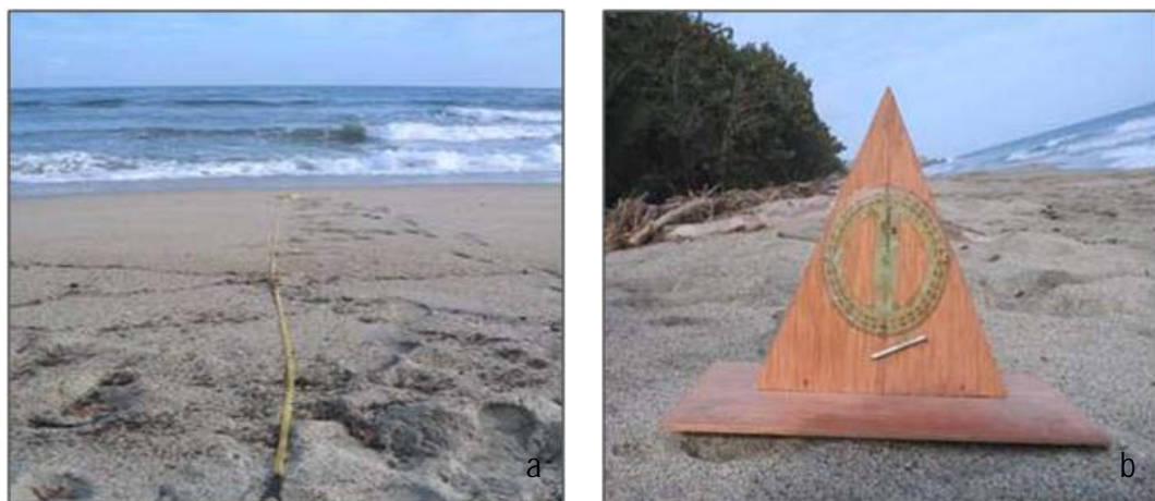
Figura 6. a. Decámetro empleado para la medición de los largos, b. Inclinómetro ajustado a campo para la medición de las inclinacion.
