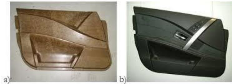
*Figure 1 Auto partes reforzadas (fuente: Art. Plásticos reforzados con fibras naturales)*
