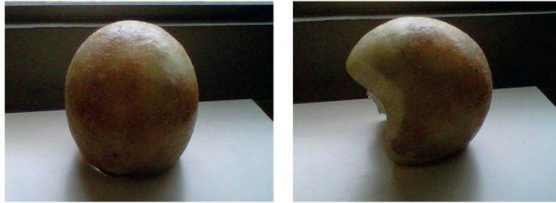
Modelo de comprobación de resistencia en fibra Aramida
