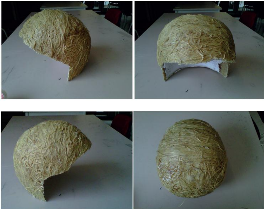
Modelo de comprobación de resistencia en fibra Aramida
