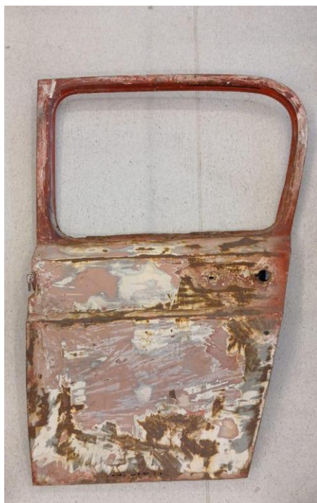
Figura 2 Foto puerta oxidada
