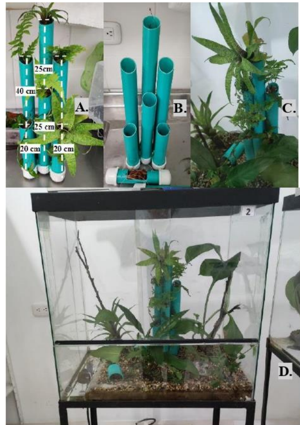
Fig 4. A. Montaje 2 con base en tapas de PVC. B. Medidas de corte para cada tubo utilizado. C y D. Montaje 2 en acuario 2.
