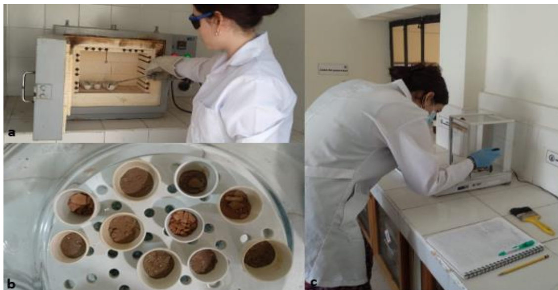
Figura 8. Determinación de materia orgánica; a) mufla a 500 °C, b) muestras en el desecador, c) peso en balanza analítica.
