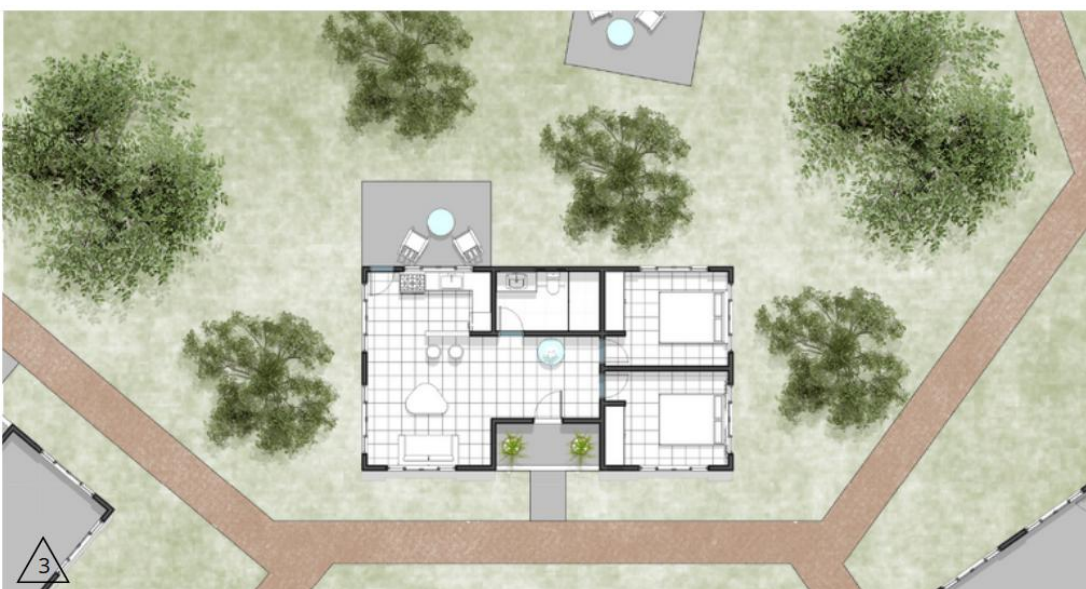
Ilustración 13 Plano módulo residencial – apoyo
