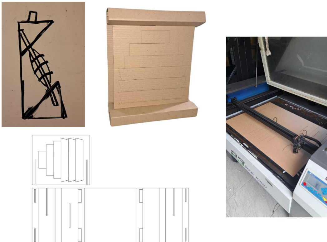
Figura 28. Diseño y modelo de dos componentes, plano para corte laser. Imagen de Autoría Propia.
