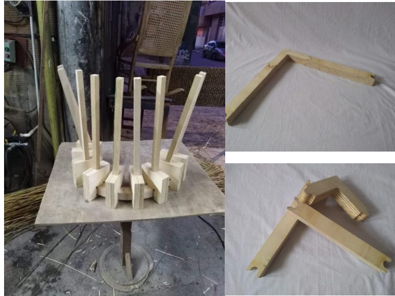
Fig. 28 Configuración y ensamble de piezas de la herramienta
