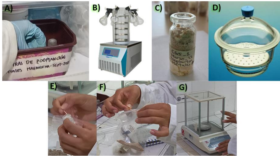
Figura 3. Procesamiento para la obtención de biomasa liofilizada. A) Congelamiento, B) Liofilización, C) Muestra liofilizada, D) Desecador, E) Maceración, F) Almacenamiento y G) Pesado
