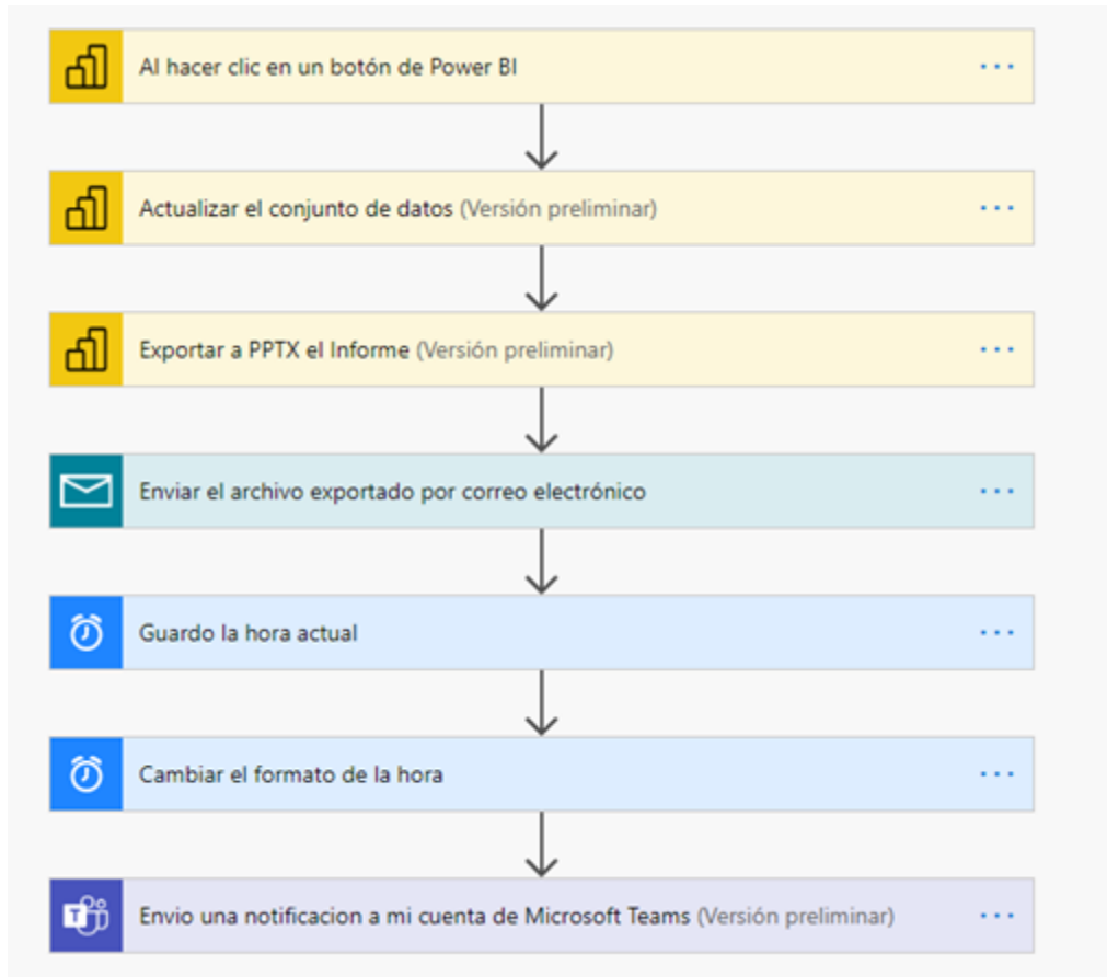
5. Ejemplo de diseño de flujo en Power Automate actualizando Power Bi.
