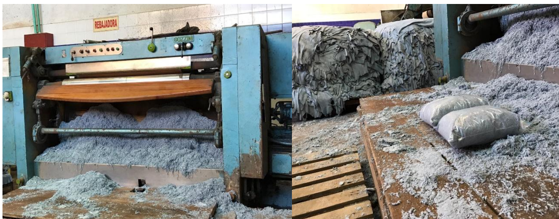
Figura 1. Obtención de las virutas de la etapa de rebajado.
