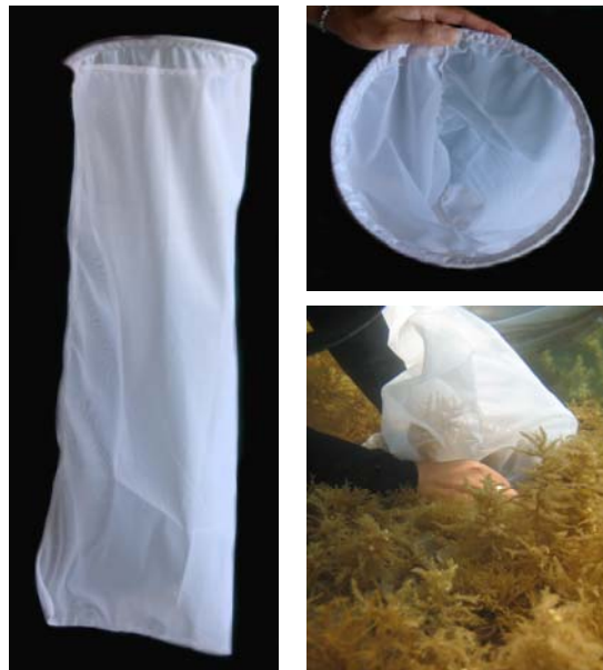
Figura 2. Malla empleada para la toma de muestras de Sargassum spp. en las tres estaciones de muestreo. A. Vista completa, malla de 1 m de altura con un diámetro de poro de 500 \mu\text{m} ; B. Boca de la malla de 25 cm de diámetro. C. Toma de muestras (Fotografías por López, 2007).
