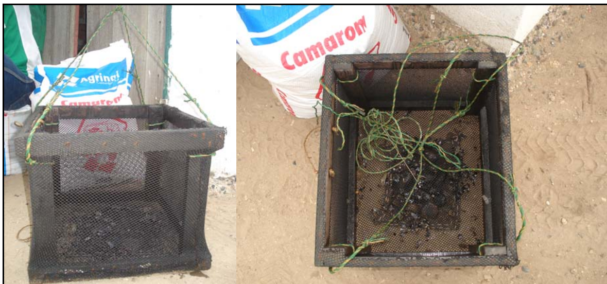
Figura 6. Cajas fabricadas en madera y malla cuya finalidad es comprobar la efectividad del tratamiento con sulfato de cobre libre en la columna de agua. Estas son instaladas con mejillones dentro de las piscinas que vayan a recibir tratamiento, y revisadas cinco días después.
