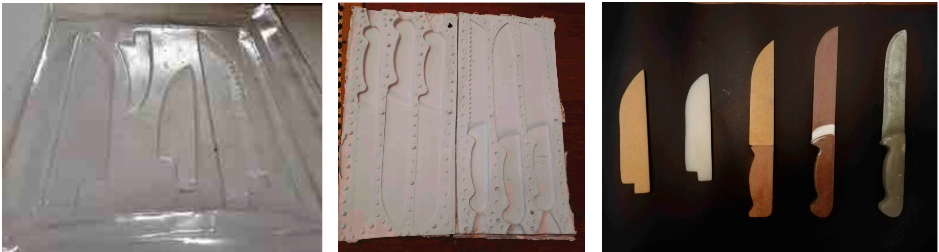
Figura 9: Molde termo formado
