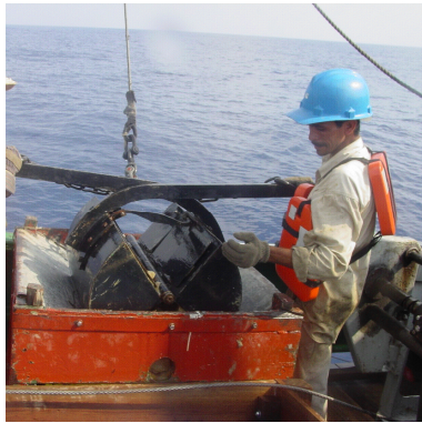
Figura 6. Toma de muestras sedimentológicas con draga Van Veen.
