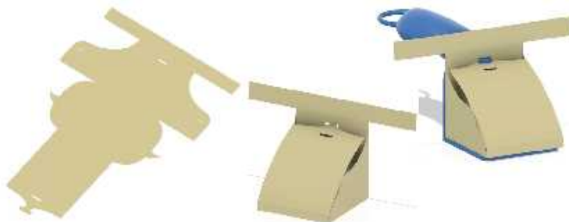
Figure 74. Elaboración propia. Empaque a base de bagazo de caña de azúcar y posicionado en el recogedor.
