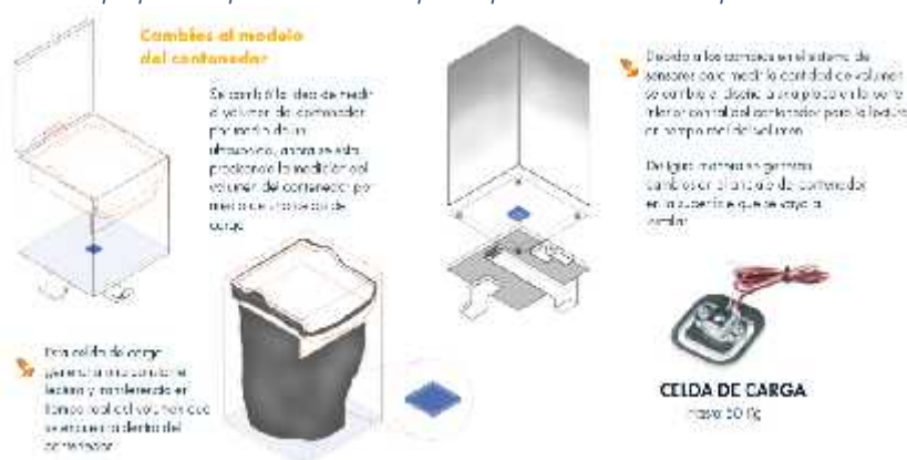
Figure 43. Elaboración propia. Maqueta usada en el prototipo de la medición de peso con celda de carga de 50 Kg.
