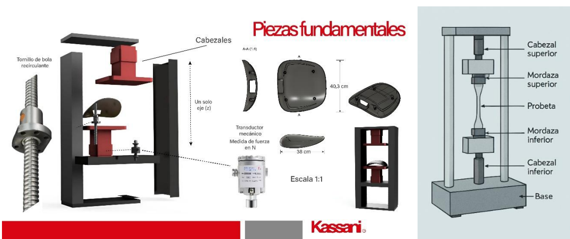
Figura 21 Máquina de ensayos universal (piezas externas)
