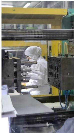
Figura 6 Inyectora de plástico, Planta de producción GR
