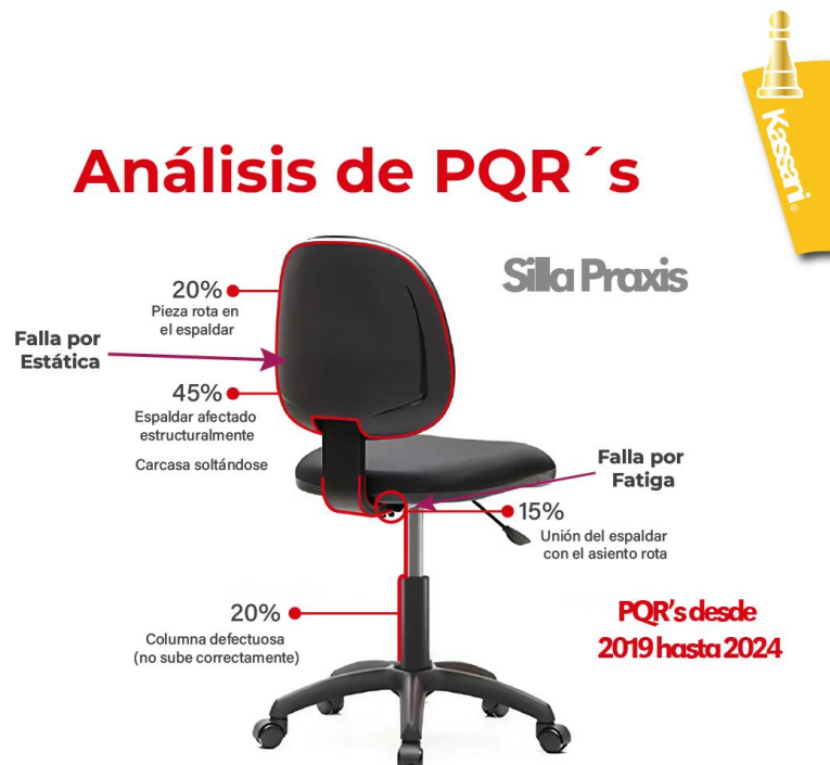
Figura 22 Falla por estática en la silla Praxis
