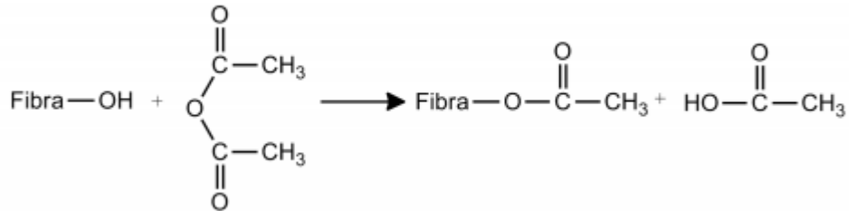
Figura 1. Reacción de los grupos hidroxilos de material lignocelulósico por tratamiento con anhídrido acético.
