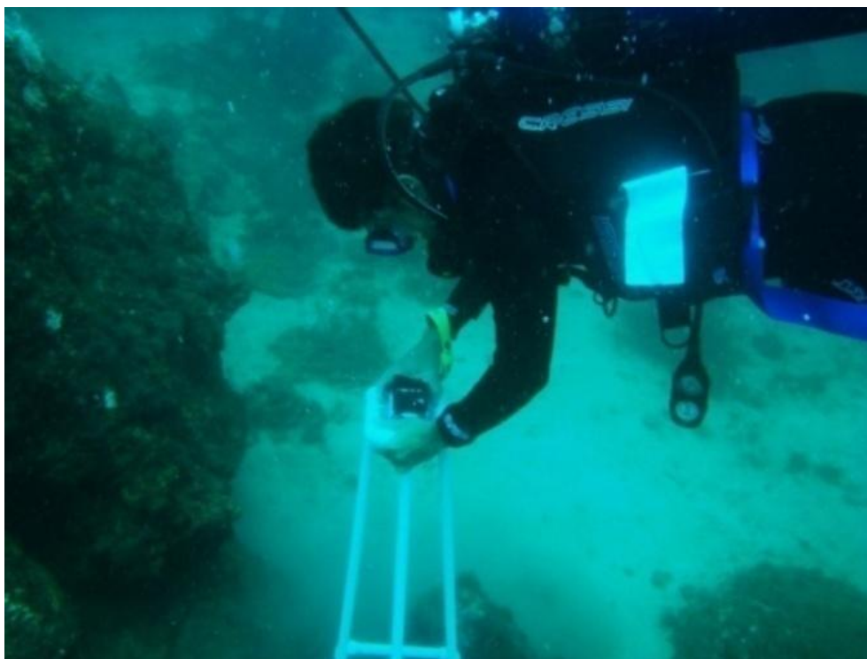
Figura 2. Buzo sobre el fondo llevando a cabo método de foto-cuadrante. Nótese la cámara situada sobre el armazón de PVC.
