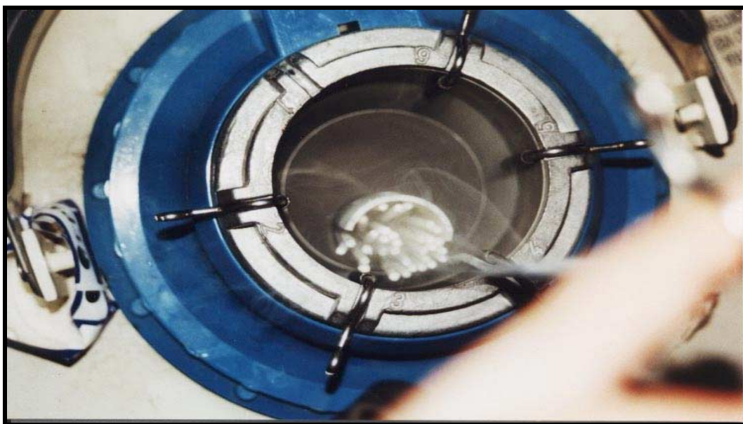
Figura 8. Cargado del tanque de almacenamiento de nitrógeno líquido con las muestras congeladas.
