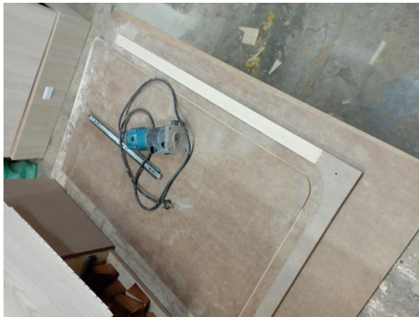
Ilustración 19. Apertura de ranura y guía para el desplazamiento del riel Fuente: Ilustración propia
