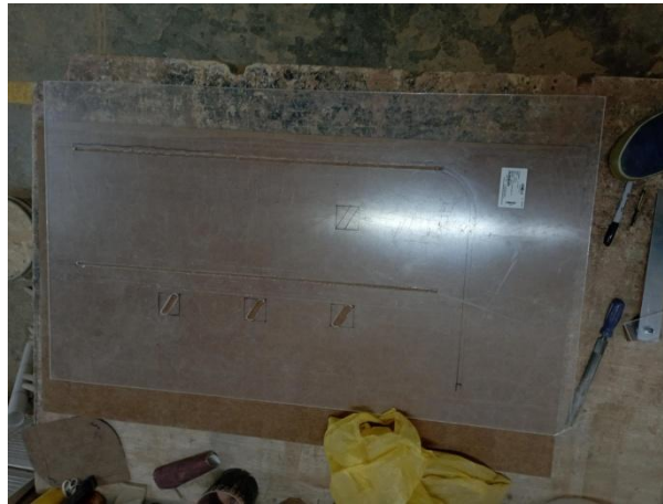
Ilustración 21. Apertura total agujeros de riel y sensores en acrílico de 5 milímetros Fuente: Ilustración propia
