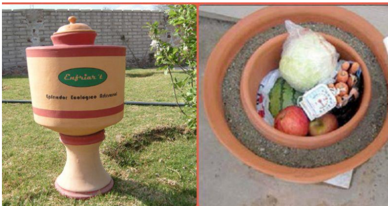
Figura 17. Refrigerador de arcilla [Imagen]
