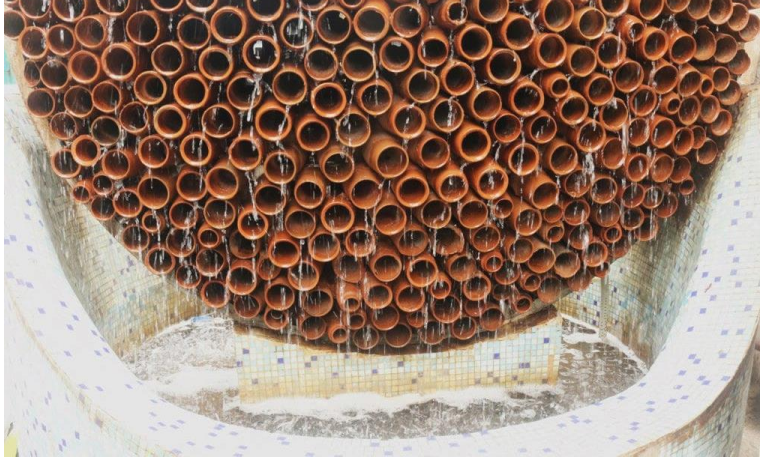
Figura 16. Climatizador de Aire Hindú [Imagen]
