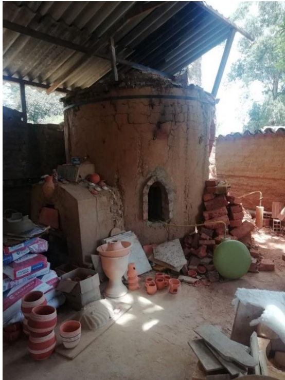
Figura 11. Horno de gas tipo colmena [Fotografía] Fuente propia.
