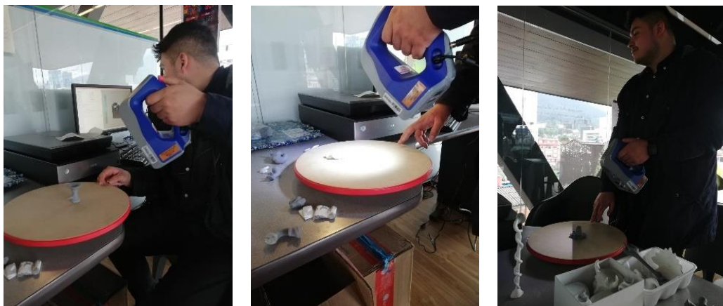
Fotografía 3. Proceso escáner 3D pieza por pieza para digitalización
