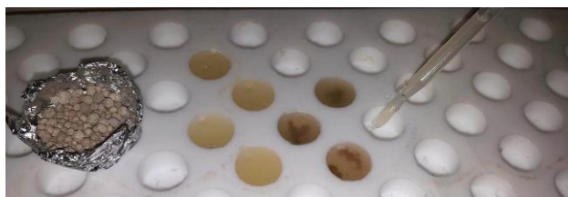
Figura 8. Encapsulación del fertilizante NPK sintetizado con la formulación 3 (3% p/v)
