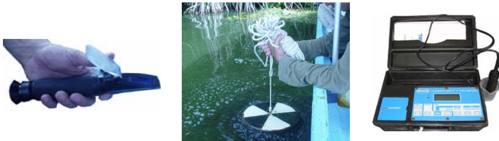
Gráfica 10. Fotografías de algunos equipos empleados. Izquierda: Refractómetro; centro: toma de la profundidad del disco secchi en campo; derecha: conductímetro. Fotografías tomadas por integrantes del grupo de Limnología UJTL, 2005.
