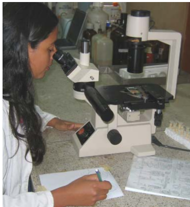
Gráfica 17. Fotografía del microscopio invertido con cámara de dibujo lateral. Fotografía tomada por integrantes del grupo de Limnología UJTL, 2006.
