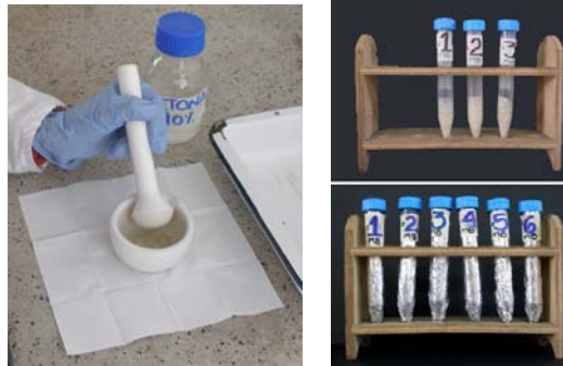
Gráfica 18. Fotografías del proceso de extracción de clorofila a. Izquierda: proceso de macerado de los filtros de clorofila a con acetona; derecha: tubos de centrifuga oscurecidos con el macerado. Fotografías tomadas por integrantes del grupo de Limnología UJTL, 2006.
