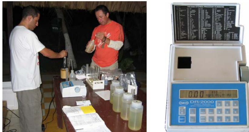
Gráfica 15. Fotografía del espectrofotómetro de campo Hach DR-2000. Izquierda: algunos miembros del Grupo de Limnología empleando el equipo para el análisis de aguas en la estación Amaya; derecha: espectrofotómetro de campo Hach. Fotografías tomadas por integrantes del grupo de Limnología UJTL, 2005.
