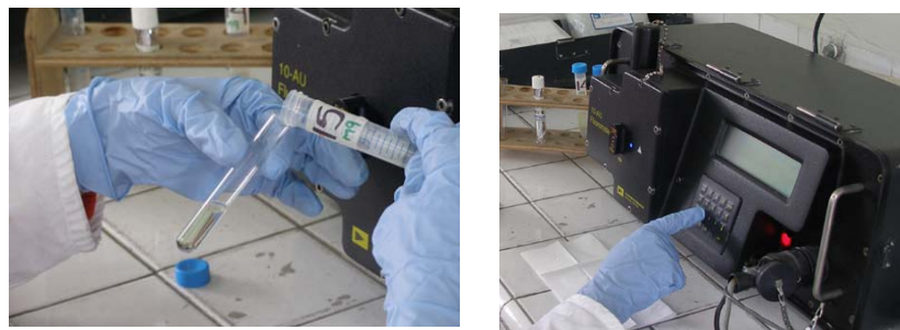
Gráfica 19. Fotografías de la medición de clorofila a por fluorimetría. Izquierda: llenado de la celda con el extracto; derecha: fluorómetro Turner Designs 10-AU. Fotografías tomadas por integrantes del grupo de Limnología UJTL, 2006.
