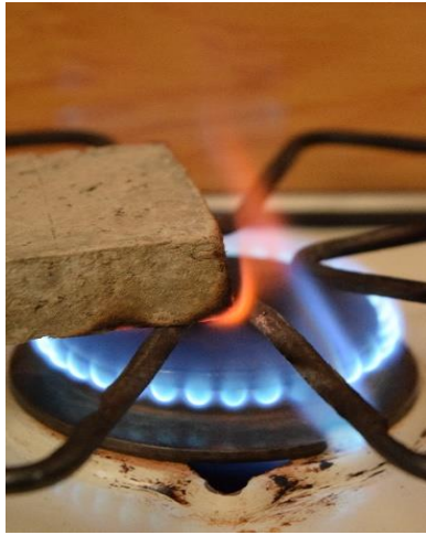
Fotografía 30 Resistencia a contacto con fuego
