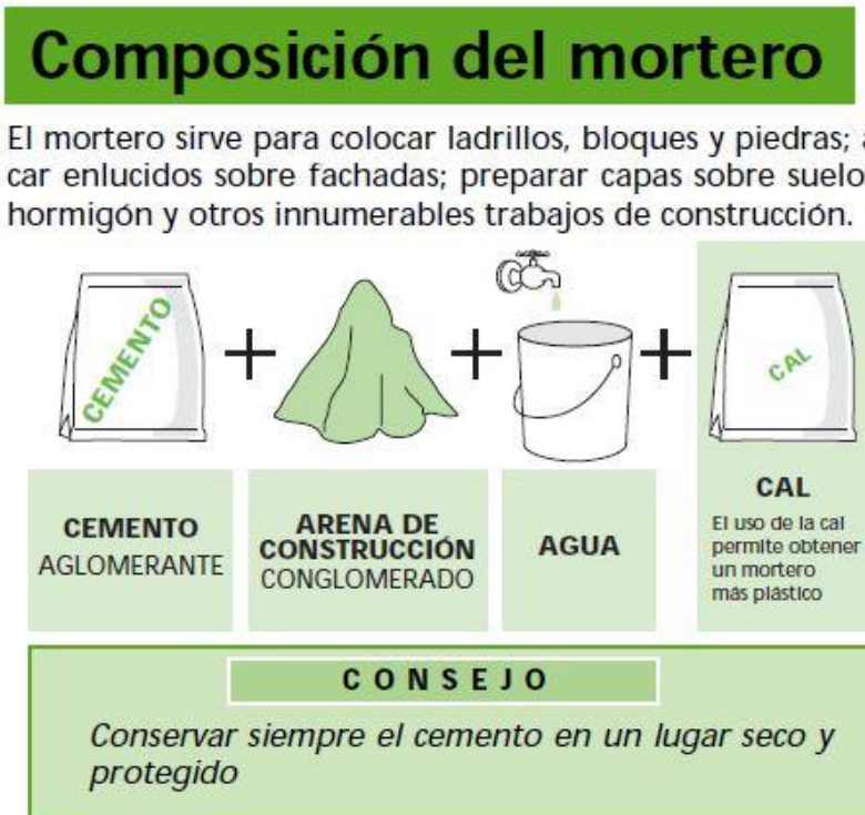
Figura 5 Composición del mortero (Leroy Merlin, 2012)
