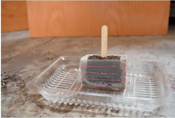
Fotografía 33 Absorción de humedad por hidratación
