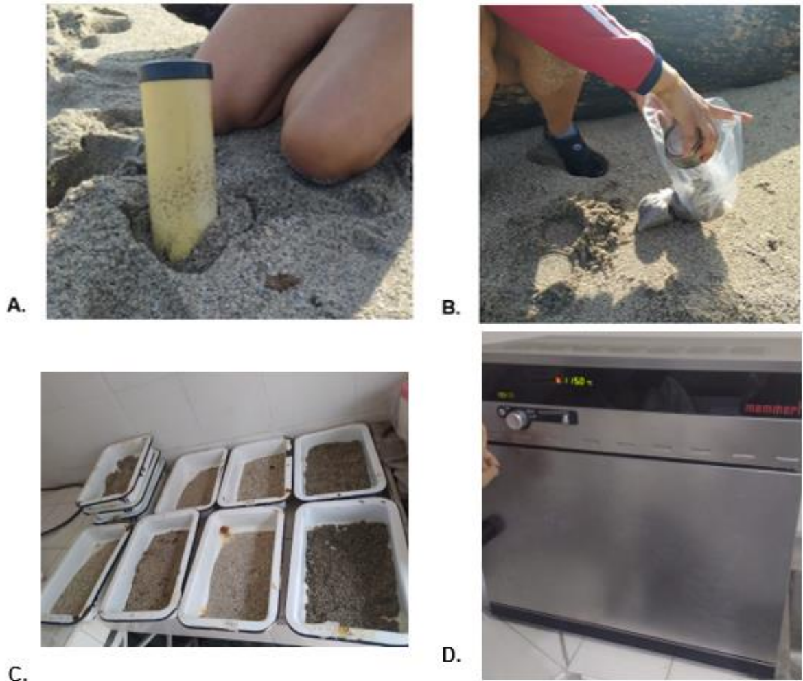
Figura 6. Primera parte de granulometría. A. Corazonador de PVC. B. Toma de muestras de sedimento. C. Secado de muestras a temperatura ambiente. D. Horno Memmert.
