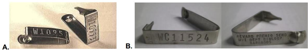
Figura 10. Placas de marcaje de tortugas marinas. A. Placa tipo Monel. B. Placa tipo Iconel. Tomado de Bernal-Gutiérrez et al. , 2020.
