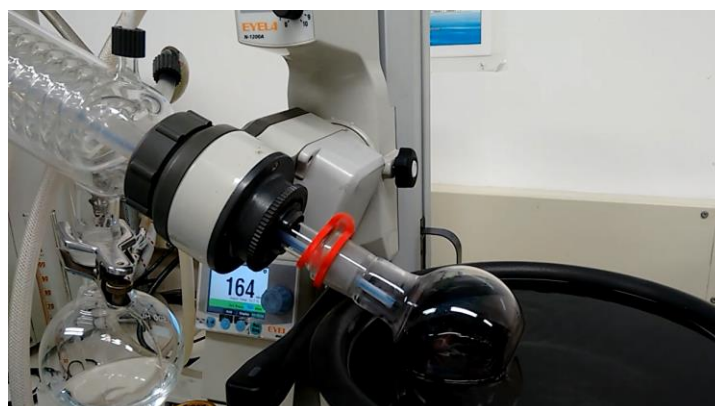
Figura 4. Concentración del pigmento de açaí usando rotoevaporador marca EYELA serie N-1200A
