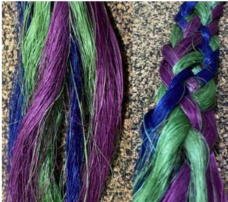
Figura 35. Proceso de trenzado de 6 cabos para la tira de cierre. Fuente: elaboración propia.
