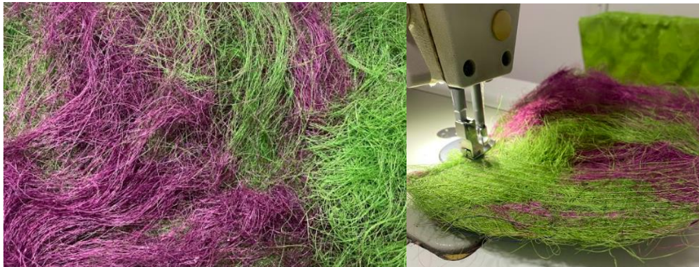
Figura 29. Fabricación del fique tizado. Fuente: elaboración propia
