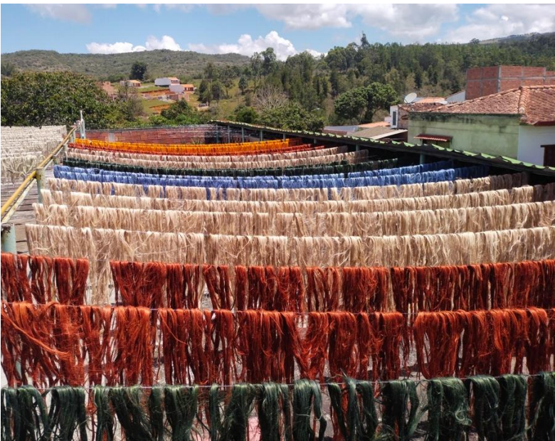
Figura 16. Fibra de fique en secado. Fuente: elaboración propia.
