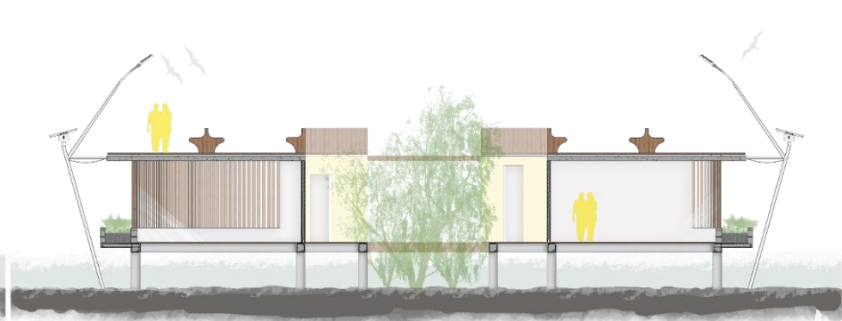
CORTE A-A – MODULO DE AULAS
