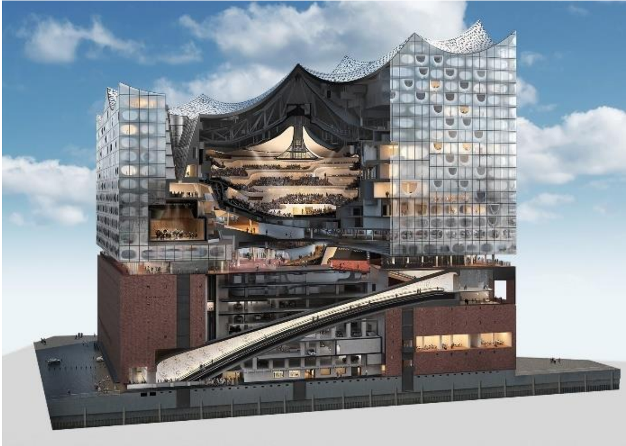
Figura 30. Continuo espacial entre el edificio antiguo y su ampliación Fuente: elbphilharmonie.de
