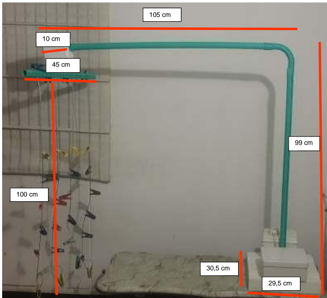
Figura 7. Medidas en centímetros de FOOD-MOVE
