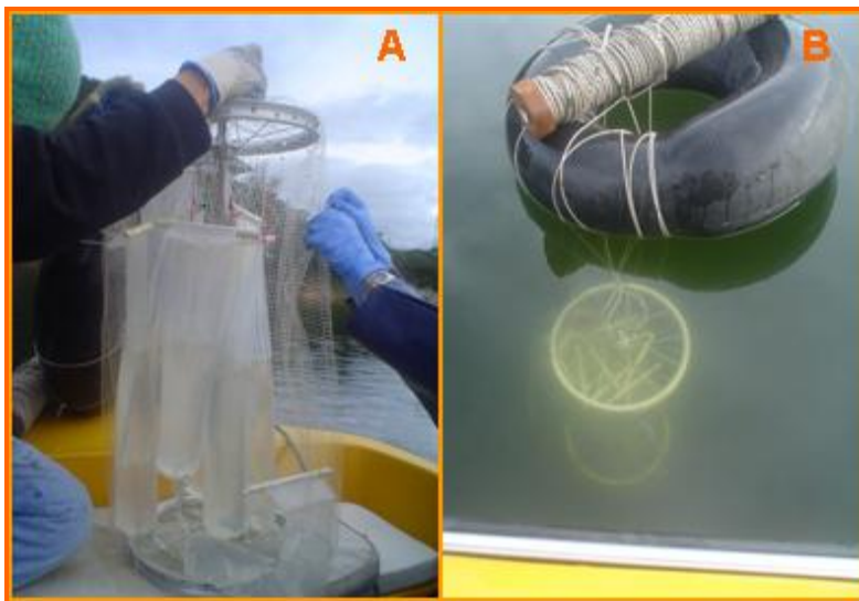
Figura 3. Montaje experimental en el embalse del Neusa. A: soporte y bolsas de diálisis en el montaje. B: diseño sumergido en la entrada del río Cubillos. Tomado de Canosa et al. 2008.
