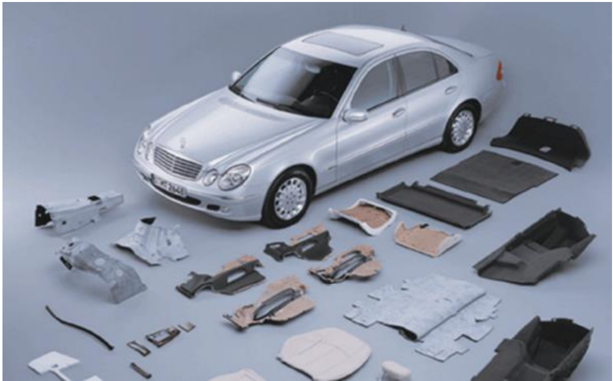
Figura 15. Materiales compuestos en autos. Tomado de A Review on Natural Fiber Reinforced Polymer Composite and Its Applications .
