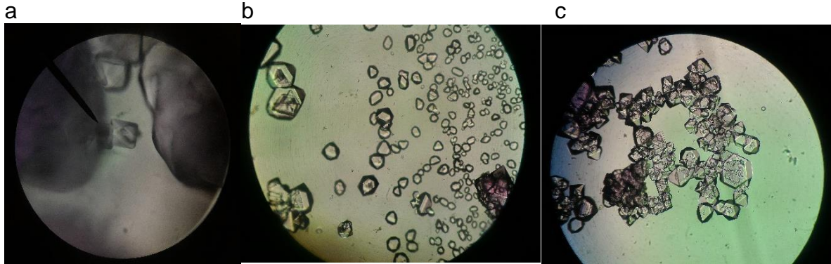
Imagen 6. Polvo recuperado de la etapa de exploración a: 20ml, b: 30ml, c: 40ml
