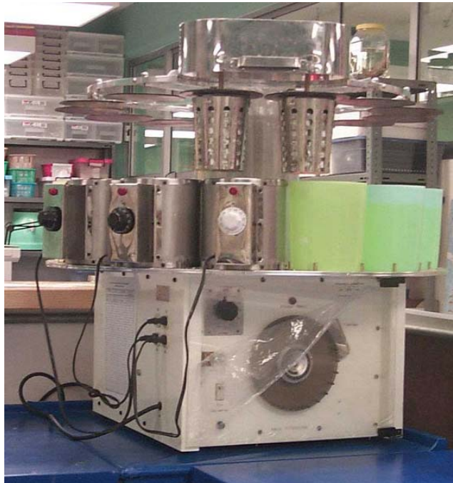
Figura 11. Procesador automático de tejidos, histoquinete modelo PT24H3B.
