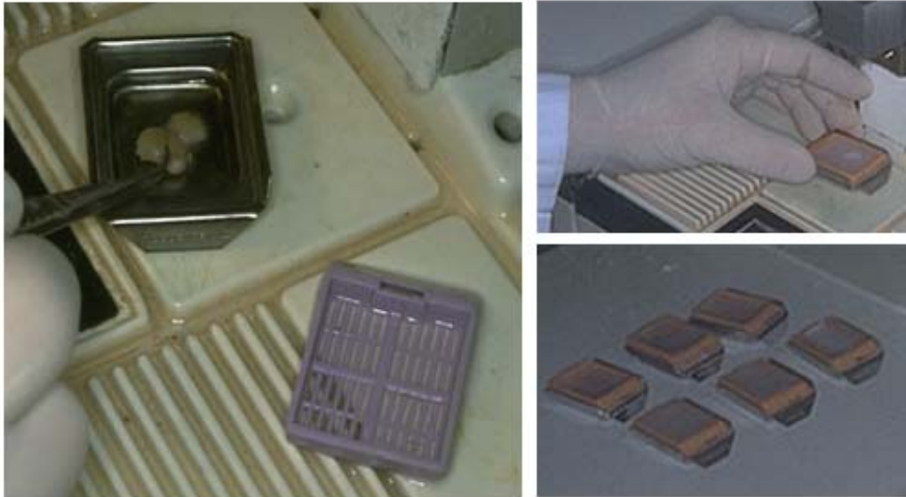
Figura 12. Proceso de inclusión en parafina y molde de acero inoxidable SAKURA. 24 x 24 x 12 mm.
